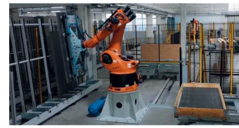
Die vertikale Beschickung der Platten ermöglicht, die Lagerkapazität zu erhöhen und die Bruchgefahr zu verringern.
